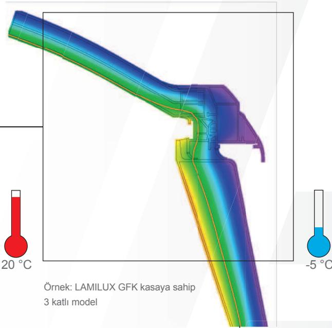
İspatlanmış, kesintisiz eşsıcaklık eğrisi akışları ortalamanın üzerinde enerji verimliliği özellikleri sağlar. Bu sayede, düşük dış sıcaklıklarda duman ve hava tahliye kapağının iç tarafında kondensat oluşma tehlikesi büyük oranda düşürülmüştür. Ayrıca, binanın içinde yüksek miktarda ısı enerjisi saklayan komple sızdırmaz bir sistem söz konusu olur.
